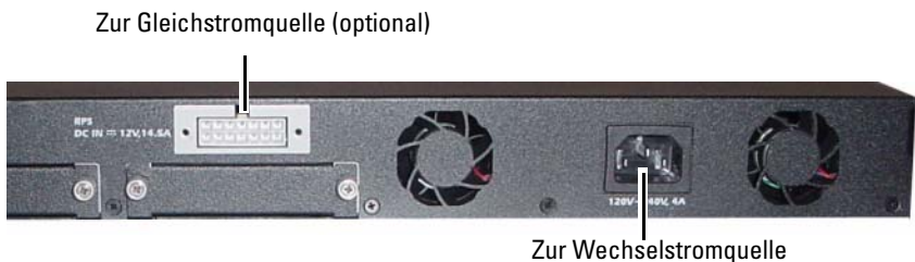
Abbildung 1-15. Wechselstrom- und Gleichstromversorgung zum Switch
